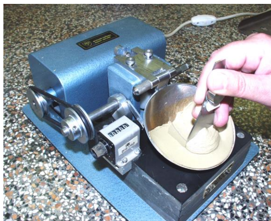
Slika 2-9. Casagrandeov uređaj u laboratorijima Instituta IGH, fotografirao ing. Ivan Šoprek
