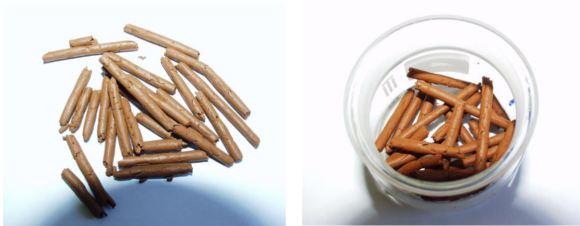
Slika 2-11. Valjčici tla na granici plastičnosti u laboratorijima Instituta IGH, desno: valjčici na granici plastičnosti u posudici u kojoj će se sušiti (fotografirao ing. Ivan Šoprek)
