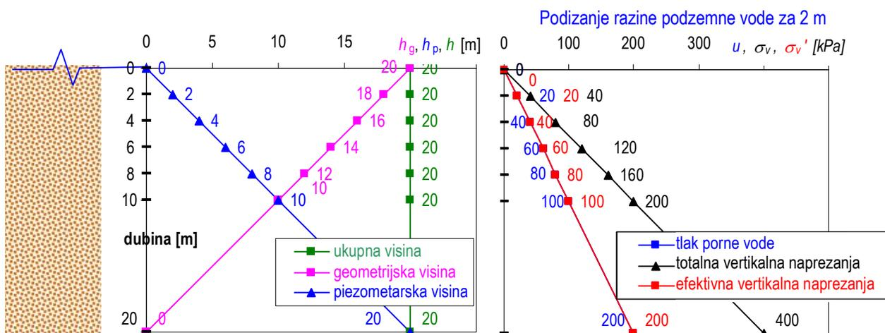
Podizanje razine podzemne vode izaziva općenito povećanje tlaka porne vode te smanjenje efektivnih naprezanja u tlu. Spuštanje razine podzemne vode izaziva općenito smanjenje tlaka porne vode te povećanje efektivnih naprezanja u tlu.
