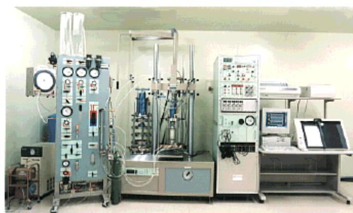
(c) Za velika opterećenja i za ispitivanje stijena ili tla pod velikim naprezanjima koriste se čelije od čelika, a za nametanje čelijskog tlaka koristi se ulje kojim se ispuni čelija.
