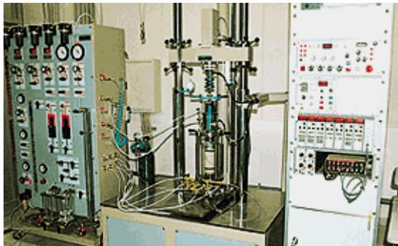
(b) U sredini: troosni uređaj, lijevo: sustav za nametanje opterećenja, desno: mjerjenje i bilježenje rezultata.
